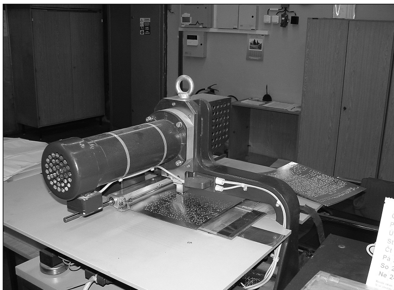
Elektrický sázecí stroj typu PUMA Vb je automatický sázecí stroj pro Braillovo písmo. Je ovládán elektronicky z počítače pomocí speciálního programu. Sáží se na matrice, ze kterých je možné reliéfní písmo vytisknout do papíru.
