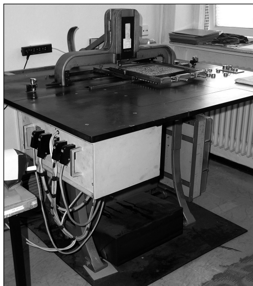
Elektrický sázecí stroj PUMA prvního typu. Sázel se Braillovým písmem do kovových matic, ze kterých je možné reliéfní text otisknout do papíru. Jedná se o stroj druhé poloviny 20. století.
