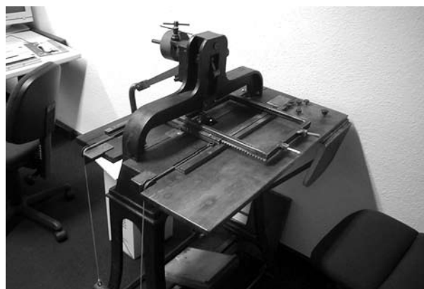
Sázecí stroj pro Braillovo písmo z r. 1895
