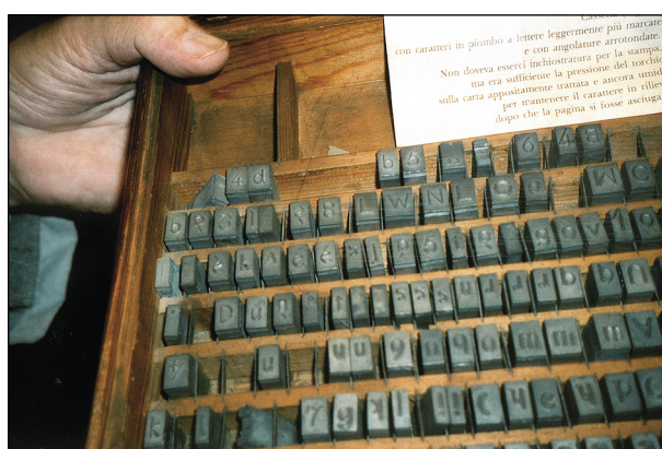
Štočky pro tisk italskou hladkou latinkou
