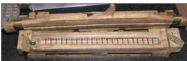
K. Em. Macan, pomůcka pro psaní Braillovým písmem
